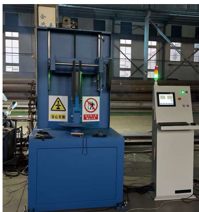
提引器可靠性、密封性、润滑温度、转动阻力测试平台
