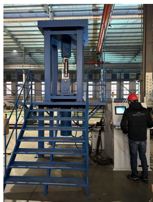
提引器可靠性、密封性、润滑温度、转动阻力测试平台
